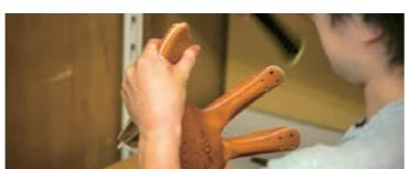
縫製はグラブ製造における花形の工程。グラブ縫製は、革の裏面同士を縫い合わせ、それを竹筒と返し棒を使い、表面にひっくり返します。力加減や棒との合わせ方など、卓越したテクニックが必要な作業です。
