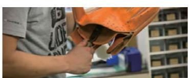
グラブは手袋2枚で構成されています。手が直接触れる「裏」と、捕球面・背面など外側を覆う「表」の2つの袋を、1つの袋にします。この作業の善し悪しでグラブの表情は変わります。フィット感に大きな差が出る、技術力が必要な作業です。
