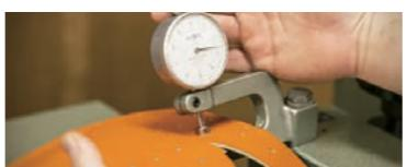
裁断した革の厚みを調整します。パート別に1.2~2.3mmに調整、それぞれのパートやポジションにより厚みを微調整します。さらに、折り返しや縫い合わせの位置に合わせてもう一度、渡きをかけます。厚みの調整は、革の状態により異なるため、人の手の微妙な感覚が重要です。
