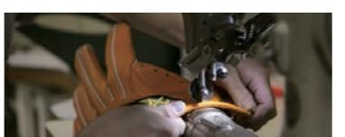
グラブの表袋の端に、幅3cmほどの革テープを縫いつけています。その革テープを巻き込んで、切り口が見えないように飾り縫いをします。ミリ単位の縫製技術が必要な作業です。
