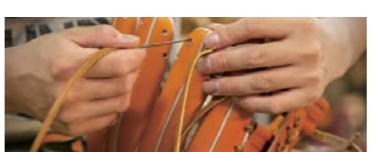
グラブ作りの最終仕上げの工程が、レースでの組み立てです。この工程により、グラブの形状が決まります。重要なのは紐の締め加減。緩めに通す部分と、きつく締める部分を熟知していかなければできない行程です。
