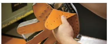
ご要望によって決定した革を、金型で裁断。基本型は10種類。プロ仕様を含めると、他に20種以上の金型があります。オーダーに応じて型を決めますが、金型がない場合は、型紙からおこしデータを作成し、自動断裁機で革を裁断しています。
